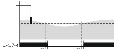
Режим откачки (трехфазный насос, поплавковый зонд)
