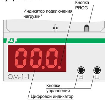
\* не горит – нагрузка отключена, горит – нагрузка включена, мигает – происходит отсчет времени до повторного включения.
