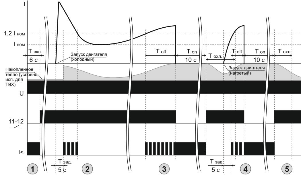
① При включении питания светится индикатор питания (U) и индикатор тока (I<), через 6 с реле входит в рабочий режим, замыкаются контакты 11-12 и индикатор тока гаснет.
